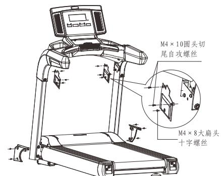
第五步：安装堵头和电源线：先用 6 个堵头将左右立杆和表头下面的安装孔塞住，最后把电源线对插到跑步机的一体式电源开关上（注意：请在对插电源线之前确保电源线为断电状态，以免造成人身安全。），如下图所示：
