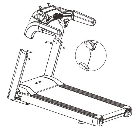
第三步：安装显示屏： 打开显示屏包装箱，取出显示屏，将显示屏上的线与表头上的线一一对应接好，然后把显示屏对插到表头上，最后用 4 个 M6×25 圆柱头内六角螺栓（带垫片）锁紧在表头上，如下图所示：
