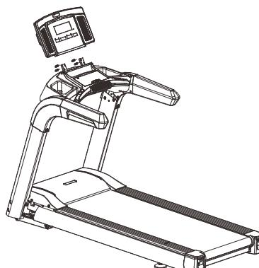
第四步：安装立杆装饰件和下表装饰件： 用 6 个 M8×8 大扁头十字螺丝，将左右立杆装饰件固定在跑台上，再用 2 个 M4×8 大扁头十字螺丝和 4 个 M4×10 圆头切尾自攻螺丝把左右下表装饰件固定在表头下面的左右立杆上。如下图所示：
