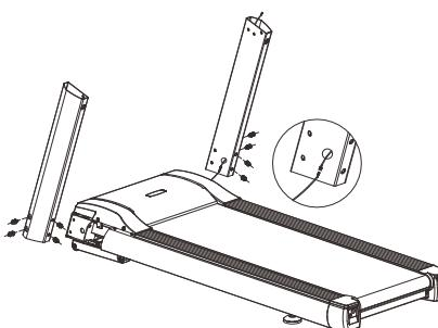
第二步：安装表头： 打开表头包装箱（A 箱），取出表头，将右立杆内的控制线与表头右下方的控制线对接好，然后将表头插入到左右立杆内，最后用 6 个 M8×16 盘头内六角螺丝（带垫片）将表头锁紧在左右立杆上。如下图所示：
