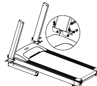
第二步：安装表头：取出表头，将右立杆内的控制线与表头右下方的控制线对接好，然后将表头插入到左右立杆内，最后用 6 个 M8×16 盘头外六角螺丝（带弹簧垫片和平垫片）将表头锁紧在左右立杆上。如下图所示：
