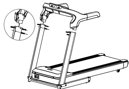
第三步：安装显示屏：打开显示屏包装箱，取出显示屏，将显示屏上的线与表头上的线一一对应接好，然后把显示屏对插到表头上，最后用 4 个 M6×25 圆柱头内六角螺栓（带弹簧垫片和平垫片）锁紧在表头上，如下图所示：
