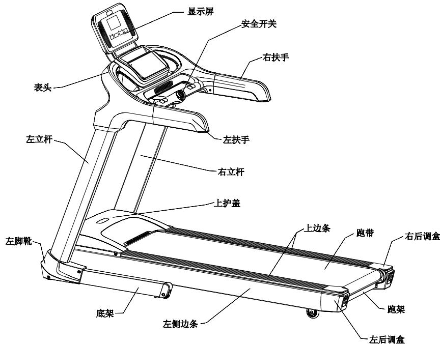
盖紧固调节螺栓，直到上跑步机没有打滑或停顿现象为止。
