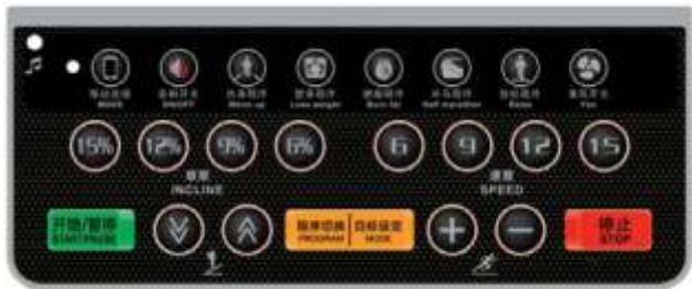
6.2.1 “程序切换”为程序键：在待机状态时，依次按此键可以循环选择内置固定程序“P1-P2---P12-U01---U03-FAT”。
