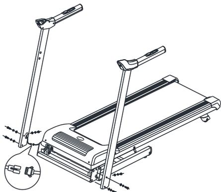
第二步：安装电子表。将立杆的控制线与电子表两端的控制线接好，然后将电子表两端插入到左右立杆内，再用 2 个 M6X25 圆柱头内六角螺丝带垫片、弹簧垫圈将表架固定在左右立杆上。注意：所有螺丝拧两圈即可，先不要拧紧。如下图所示：
