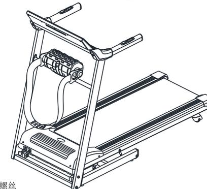
第八步: 仔细检查跑步机各部分是否紧固, 低速启动跑步机, 检查跑带各部分是否转动灵活, 跑带的松紧是否适当, 以跑带不偏移, 不打滑为准(见“电动跑步机日常保养与维护”)。检查完毕, 将跑步机移至适当的位置, 就可以投入使用了。
