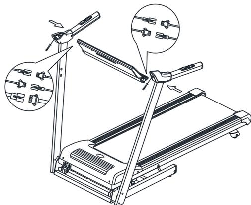
第三步：安装按摩头固定件。将按摩头固定件两端孔位与左、右立杆孔位对准，然后用 4 个 M8X16 盘头内六角螺丝带垫片、弹簧垫圈拧上，这时将立杆、电子表及按摩头固定件上的螺丝逐个拧紧。如下图所示：
